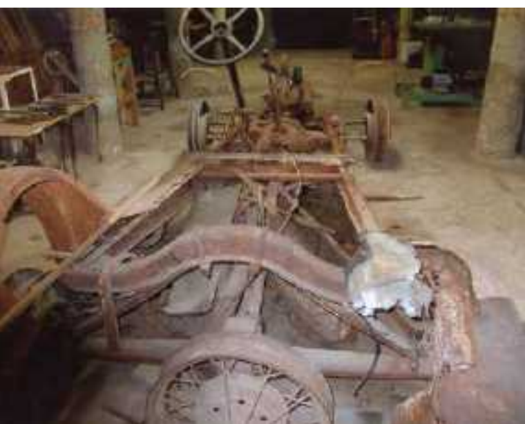
PRIMA DEL RESTAURO: IL TELAIO IN LEGNO DELL'AUTO
