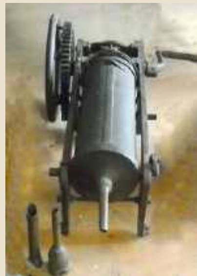
Macchina insaccatrice per la formazione di salami, salsicce e cotechini, funzionante a manovella primi anni '50
