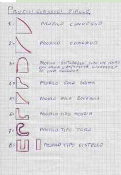
Vari tipi di profili ricavati con le pialle
